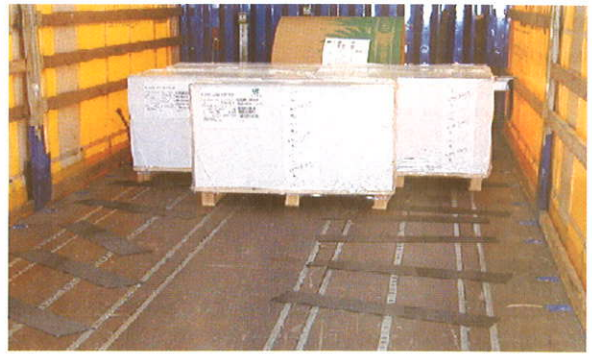
Sicherung von Paletten gegen Verrutschen auf glatten Ladeböden
